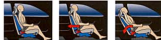
ウィップス WHIPS (後部衝撃吸収リクライニング機構付フロントシート) 時速15〜30kmの低速時の衝突でも起こりやすい、むち打ち対策として開発され た新世代のシート。衝撃吸収リクライニング機構により、追突事故での首骨や首に かかる負担をやわらげます。
